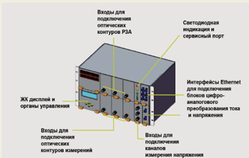
▲ «АВОК – диск размером с тарелку и электронный блок обработки данных. Такая конструкция занимает гораздо меньше места, чем стандартный трансформатор», – отметил Александр Иванов, начальник Департамента технического развития ОАО «Ленэнерго»
