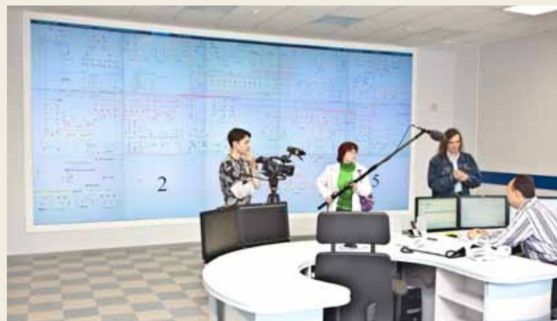
▲ На диспетчерском пульте смонтирована видеостена из 15 современных видеокубов со светодиодными (LED) экранами производства Mitsubishi
