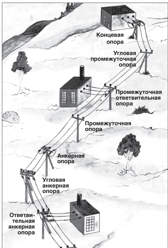
Промежуточная угловая опора Применяется на угол поворота ВЛ на 20°
