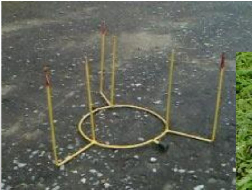
**Шаблон для определения углов при установке раскрепляющего**
